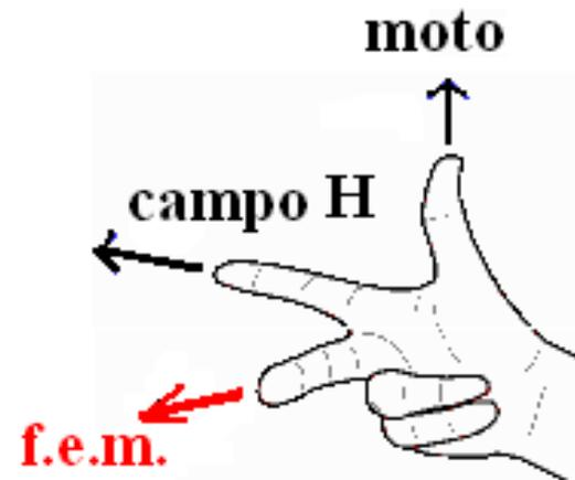
Ad un conduttore che si muove in un campo magnetico si induce ai suoi capi una forza elettromotrice (f.e.m.)
